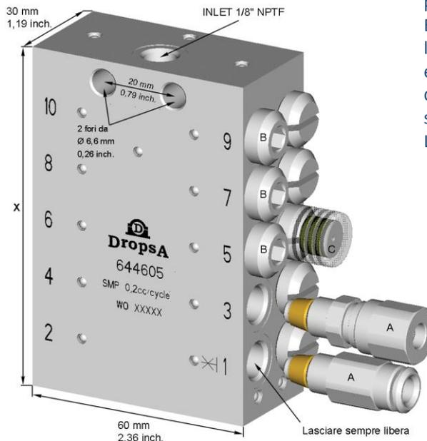
Los caudales de las salidas adyacentes pueden unirse tapando 1 o más salidas. En el ejemplo tapando la salida 8 el lubricante pasa a la siguiente salida ( por ejemplo la numero 6) en orden descendente. En caso de taparse la salida numero 2 el lubricante pasa a la 1. La salida 1 nunca puede taparse.
